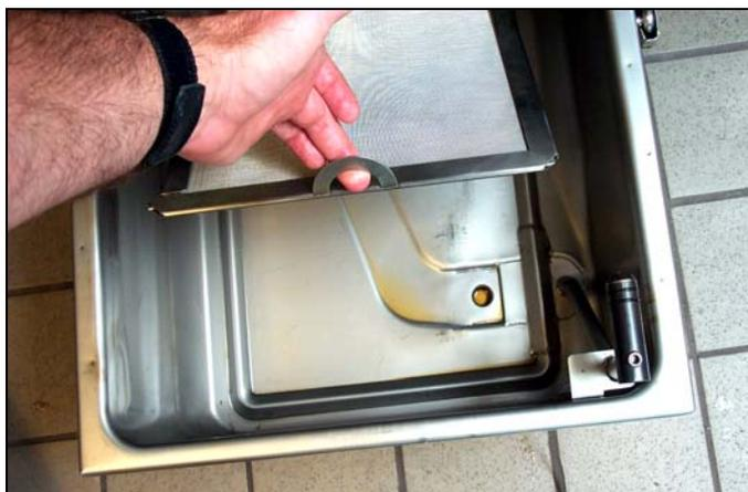
Remettez l'ensemble du filtre dans le bac, en vous assurant que le raccord situé en bas est solidement calé dans l'orifice au fond du bac. Saupoudrez uniformément une tasse de poudre à filtre Magnasol XL sur le filtre.
