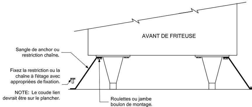
**REMARQUE :** Avant de déplacer une friteuse équipée de pieds, retirez le poids de chaque pied. Si un pied est endommagé, contactez un agent de maintenance pour une réparation immédiate ou son remplacement.
